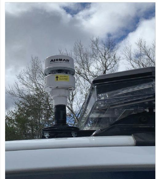
Imagen 2. [Estación meteorológica](#) montada.
