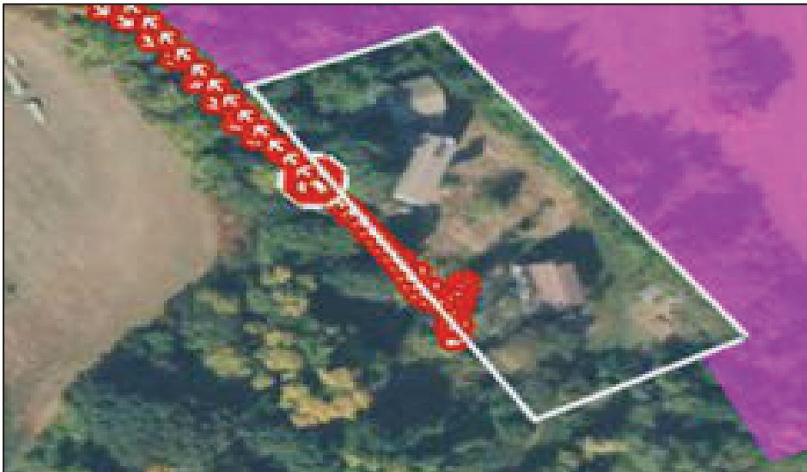
Imagen 5. Aparece con la propiedad con restricciones en color morado y la ruta de viaje en rojo, indicando que el rociado fue cancelado.
